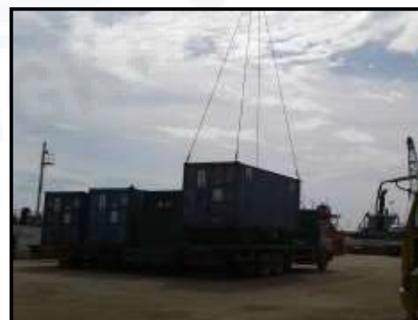
proses pengangkatan peti kemas dari chassis truck menuju kapal
