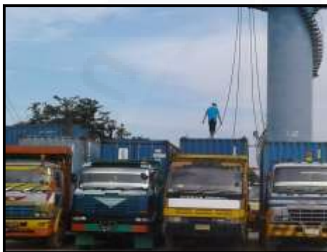
Proses pemasangan tali crane pada peti kemas diatas chassis
