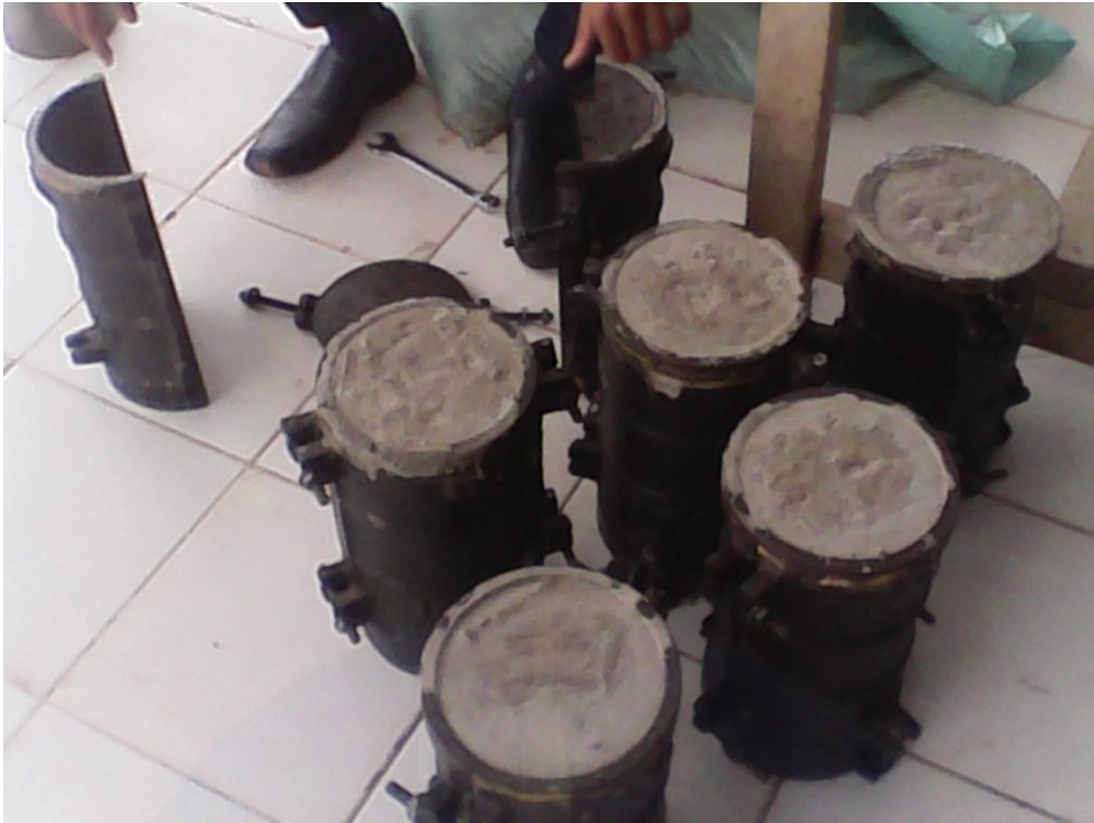
Gambar L.D.21 Proses Pelepasan Cetakan Untuk di Rendam
