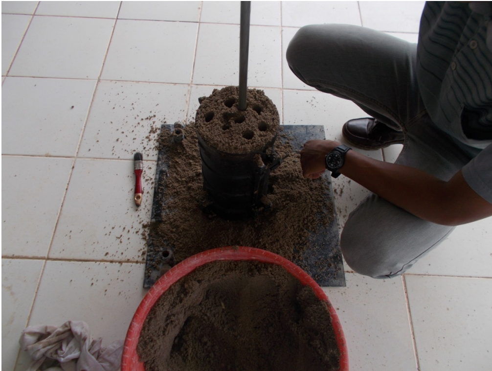
Gambar L.D.9 Proses Pengisi Berat Isi dalam Cetakan
