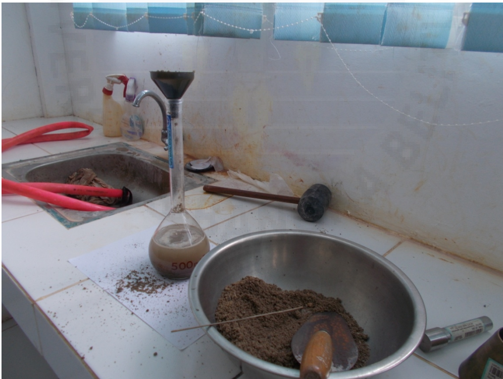
Gambar L.D.10 Proses pengujian berat jenis dan penyerapan agregat halus
