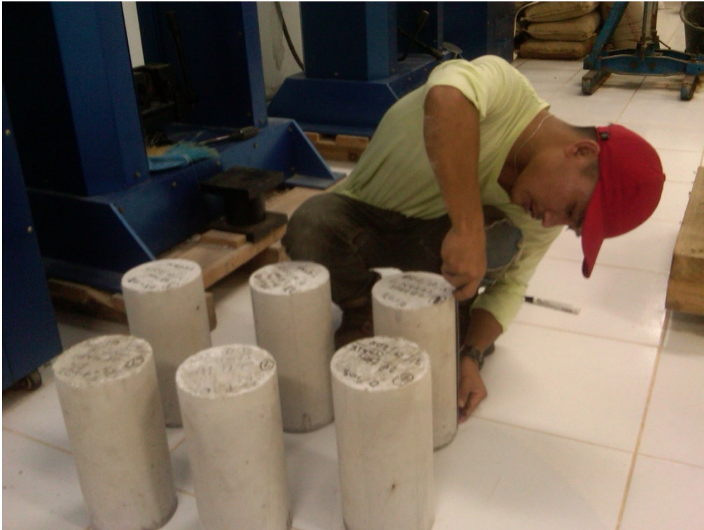
Gambar L.D.23 Proses Pengukuran Tinggi dan Diameter Benda Uji Saat Pengujian
