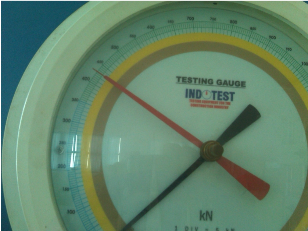
Gambar L.D.27 Pengambilan/Pembacaan Saat Benda Uji di Tekan
