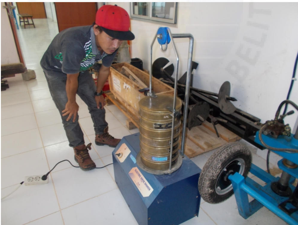
Gambar L.D.6 Analisa Saringan Agregat
