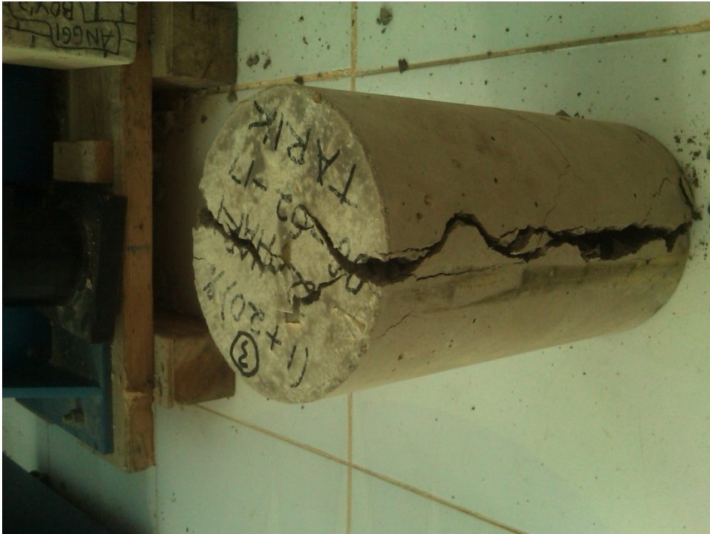
Gambar L.D.29 Pola Keretakan Kekutan Tarik Belah Beton
