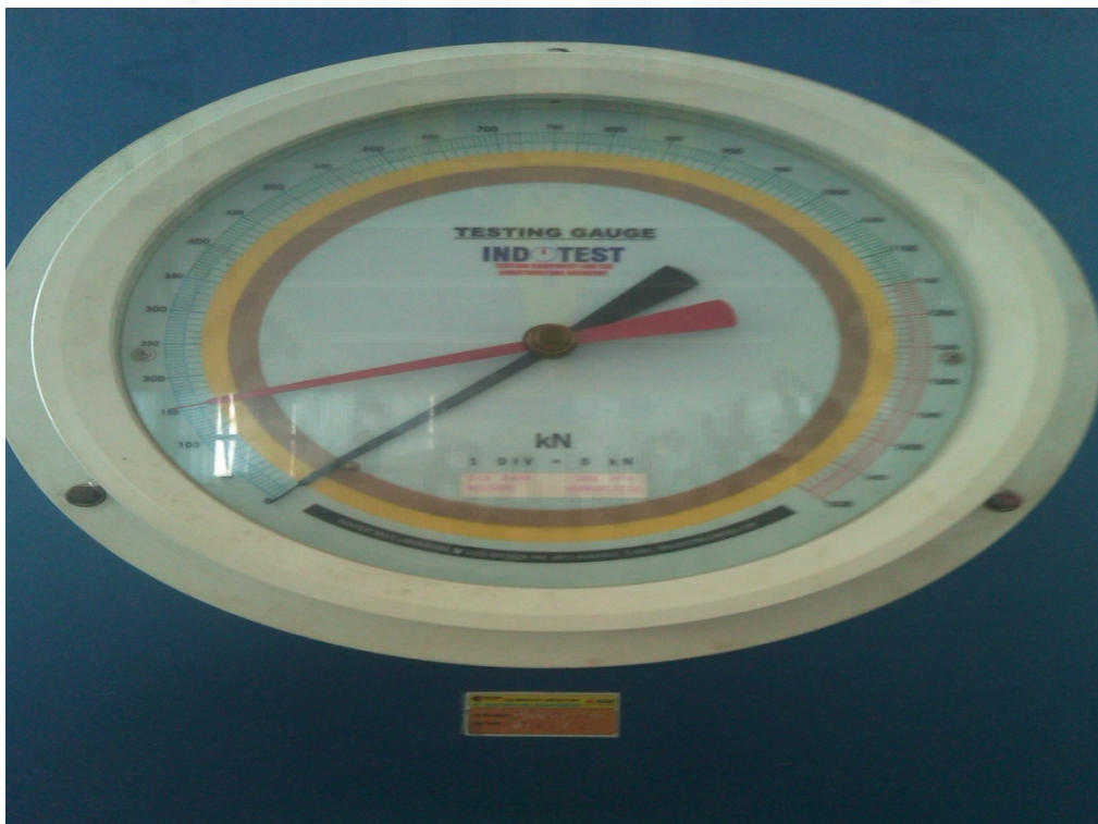
Gambar L.D.30 Angka Penunjukaan Hasil Kekutan Tarik Belah Beton
