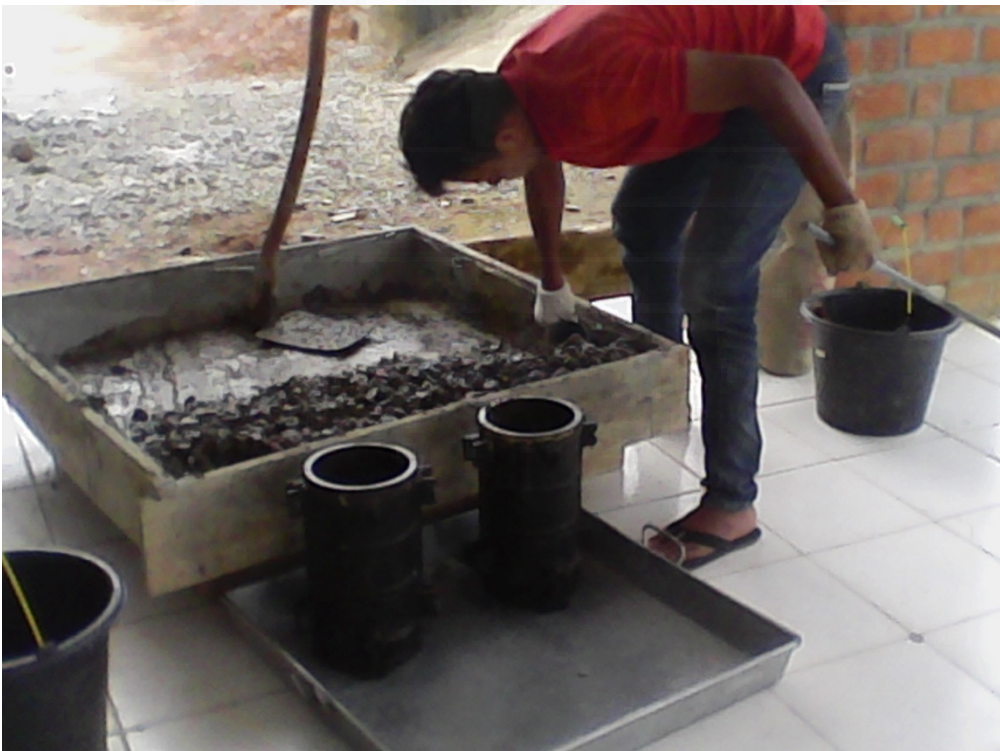
Gambar L.D.20 Proses Pembuatan Cetakan Selinder
