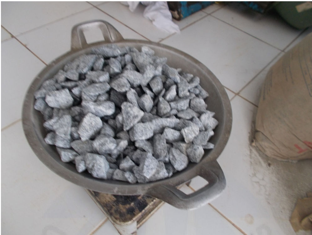
Gambar L.D.13 Proses Pengeringan Berat Jenis Dan Penyerapan Agregat Kasar
