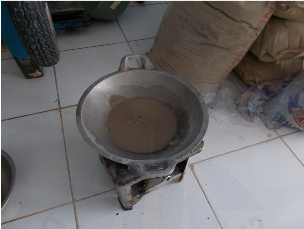
Gambar L.D.11 Proses Pengeringan Berat Jenis Agregat Halus
