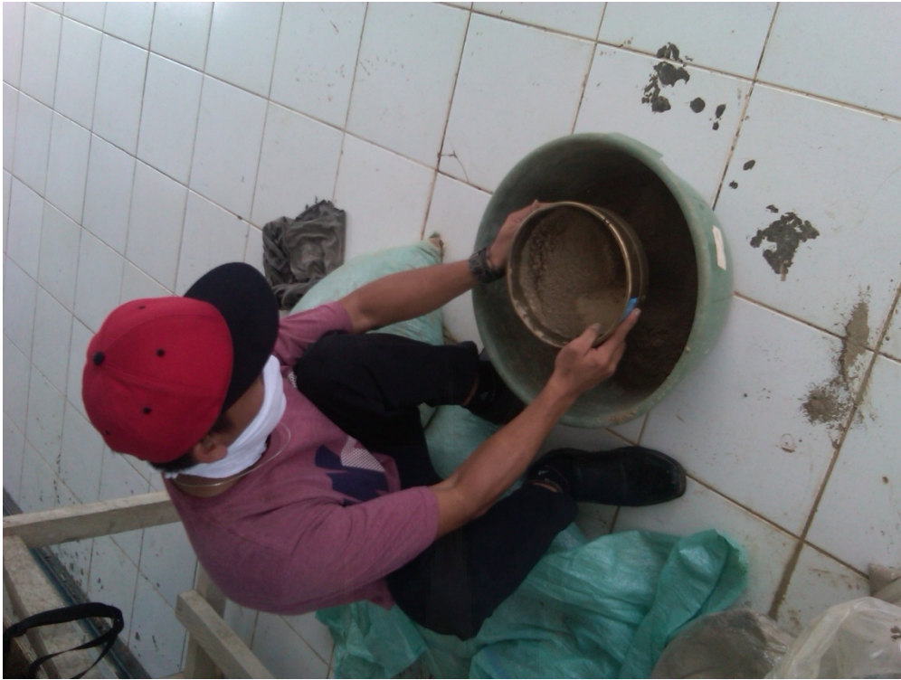
Gambar L.D.5 Proses Penyaringan Fly ash
