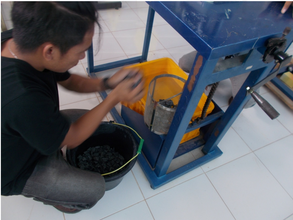
Gambar L.D.12 Proses Pengujian Berat Jenis Dan Penyerapan Agregat Kasar
