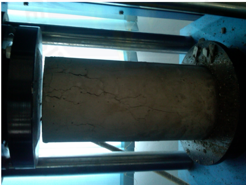
Gambar L.D.26 Proses Tekan dan Pola Retak Benda Uji saat di Tekan
