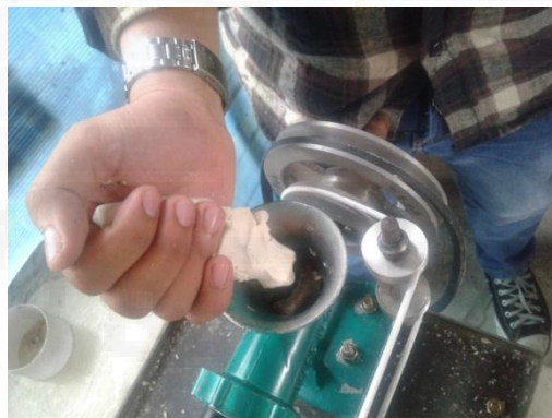
Proses Memasukan Adonan ke Dalam Mesin
