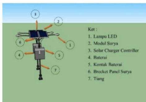
Gambar 3. Komponen PJU berbasis tenaga surya
