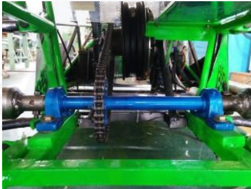
Gambar 1.1 Poros mobil listrik Tarsius V 6.0
