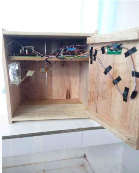
Gambar B.3 Pemasangan komponen ke boks peralatan
