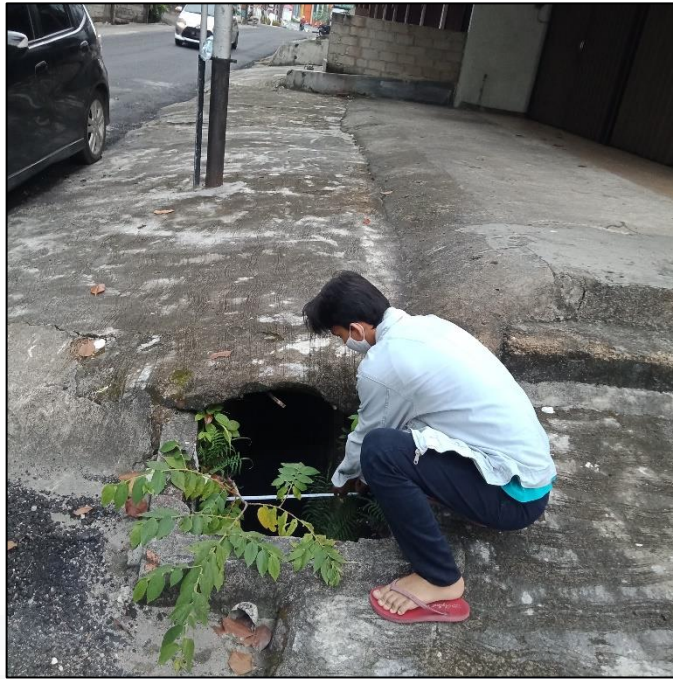
Pengukuran lebar atas saluran sekunder.
