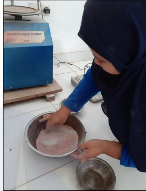
Pencampuran Tanah Lempung + Bahan Tambah
