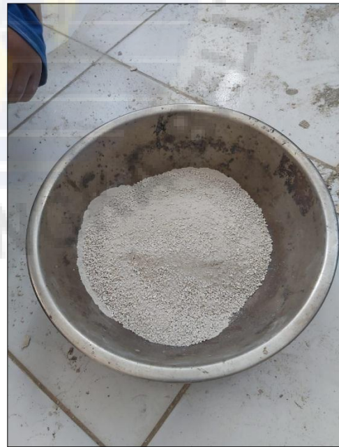
Serbuk Cangkang Kerang yang Lolos Saringan No.10 dan Tertahan No.40
