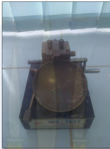
Gambar 3.3 Mangkok Kuningan untuk Pengujian Batas Cair
