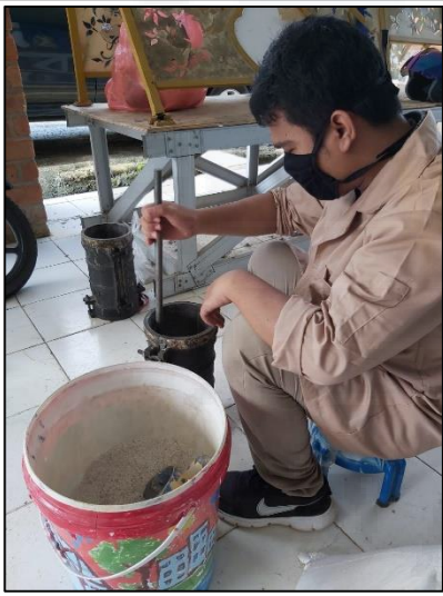
(a) dan (b) Proses Penumbukan Agregat Halus dan Semen Ke Dalam Silinder Uji Berat Isi Padat
