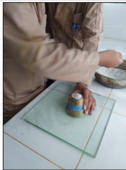
(b) Proses Memasukan Agregat Halus Dalam Kerucut Terpancung
