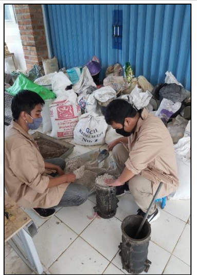
(c) Proses Memasukkan Agregat Halus dan Semen Ke Dalam Silinder Uji Berat Isi Lepas
