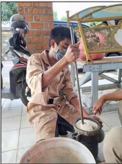
(a) dan (b) Proses Penumbukan Agregat Halus dan Semen Ke Dalam Silinder Uji Berat Isi Padat
