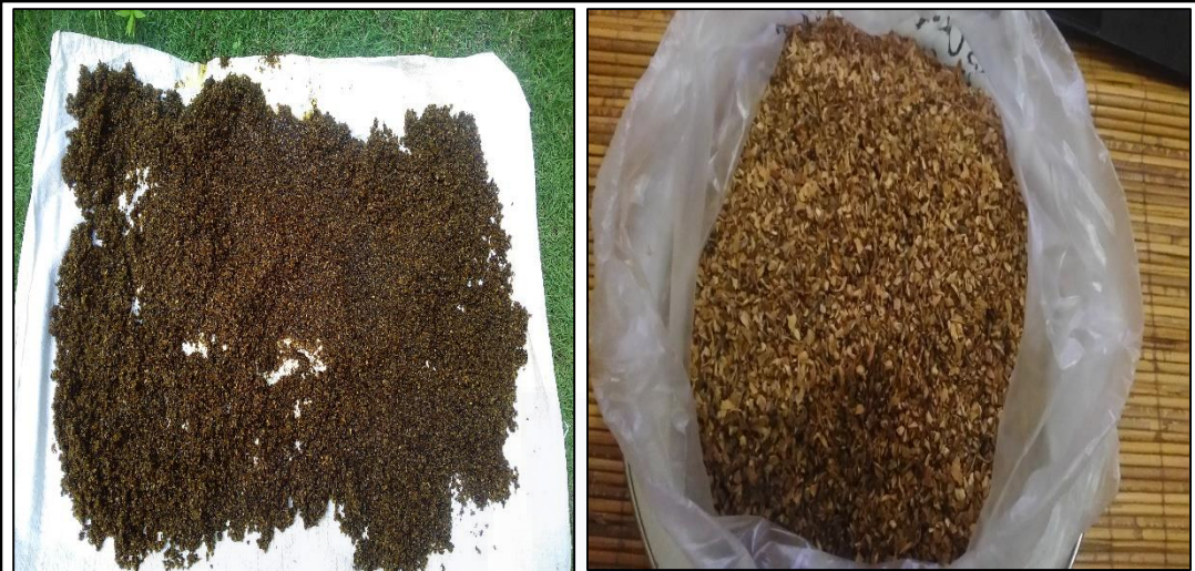
(a) Penjemuran serbuk cangkang buah karet setelah direndam dengan NaOH (b) Serbuk cangkang buah karet setelah kering
