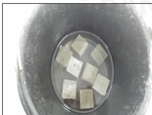
(a) Proses Perendaman Benda Uji Setelah Ditimbang SSD
