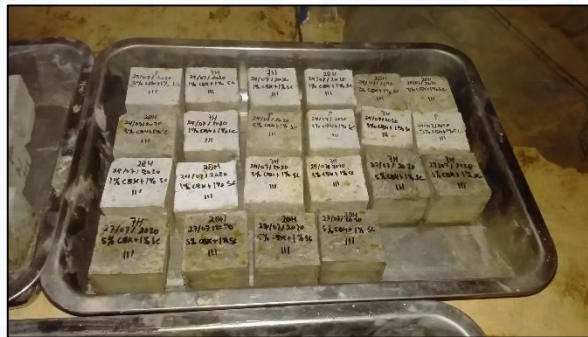
(c) Proses Perawatan Benda Uji Tanpa Perawatan (Tanpa Direndam dan Disiram)
