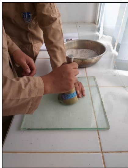
(a) Proses Penumbukan Agregat Halus Dalam Kerucut Terpancung
