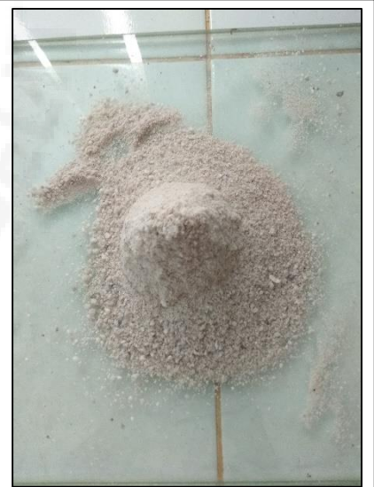
(c) Hasil Uji Keadaan SSD Agregat Halus Menggunakan Kerucut Terpancung
