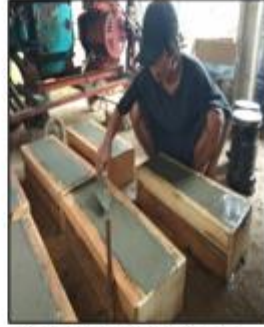
b. Pengisian adukan ke dalam cetakan balok
