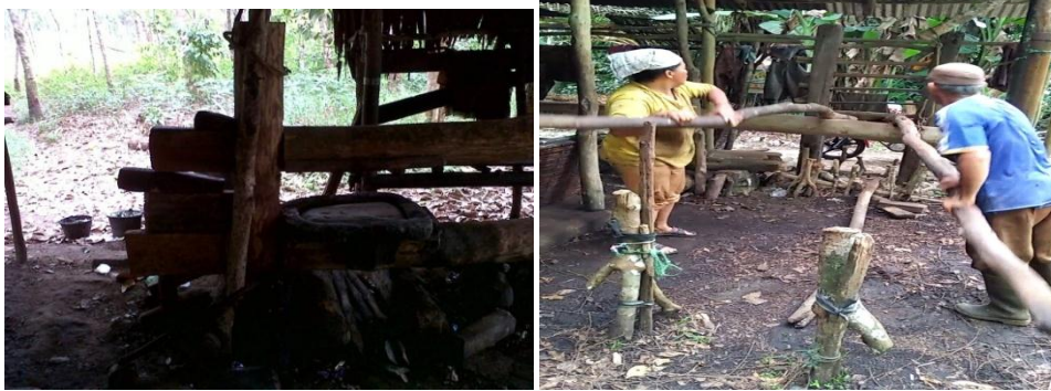
Gambar1.1 a.Mesin press getah gambir konvensional.
