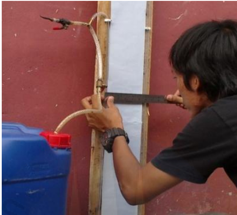
Gambar 1.7 Pengukuran tekanan biogas
